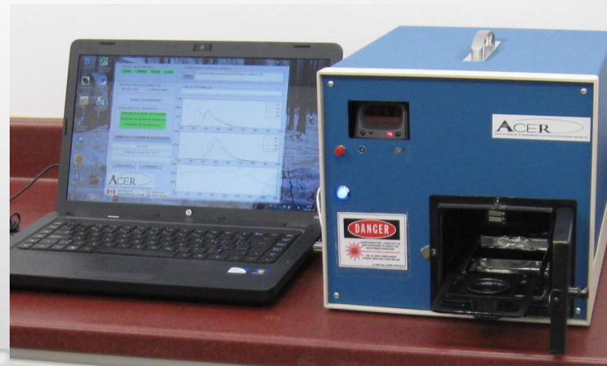
1 er prototype Spectracer I validé sur le terrain (2011) (Défauts de saveur et adultération)
